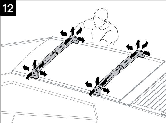
크로스바가 안전하게 설치되었는지 여부를 테스트하려면 모든 방향으로 강하게 당겨봅니다. 네 개의 타워 중 어느 하나에서라도 움직임이 관찰되면 6단계부터 9단계까지를 반복한 후 설치 상태를 다시 테스트하세요.
