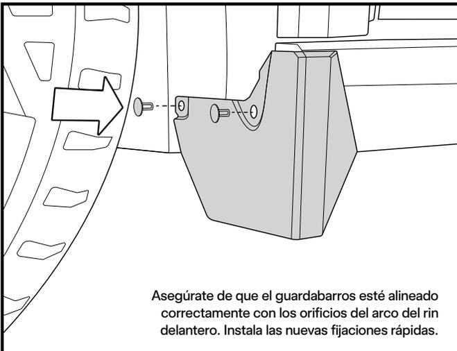
Asegúrate de que el guardabarros esté alineado correctamente con los orificios del arco del rin delantero. Instala las nuevas fijaciones rápidas.
