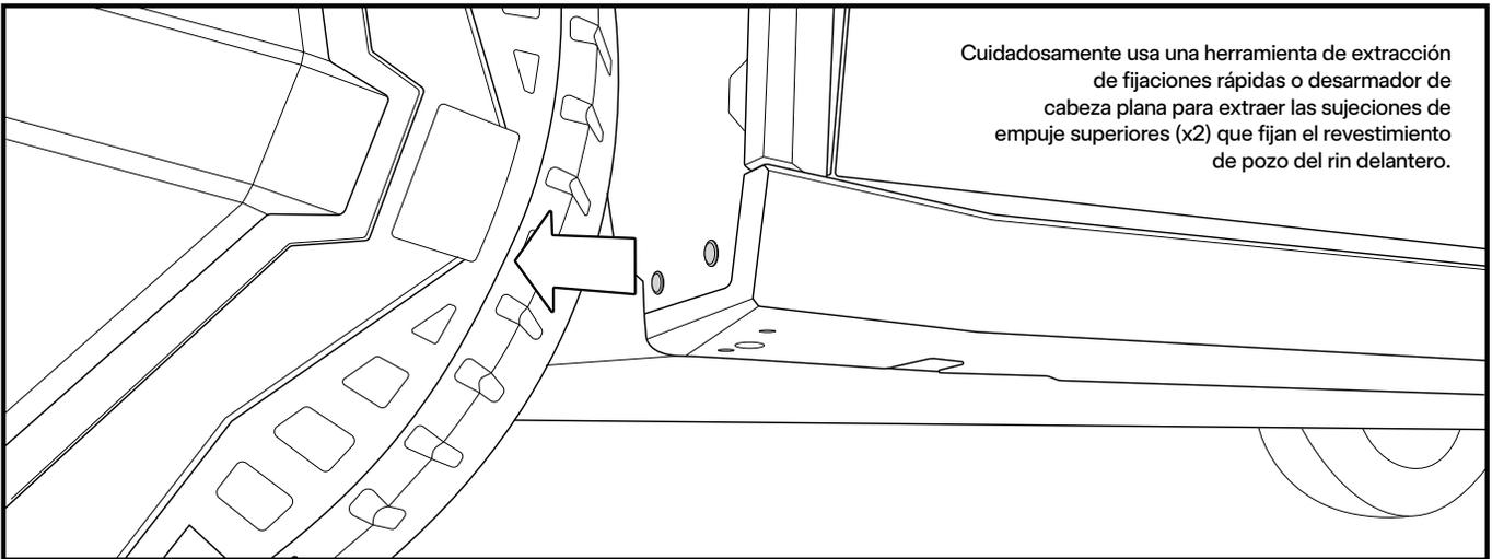
Cuidadosamente usa una herramienta de extracción de fijaciones rápidas o desarmador de cabeza plana para extraer las sujeciones de empuje superiores (x2) que fijan el revestimiento de pozo del rin delantero.
