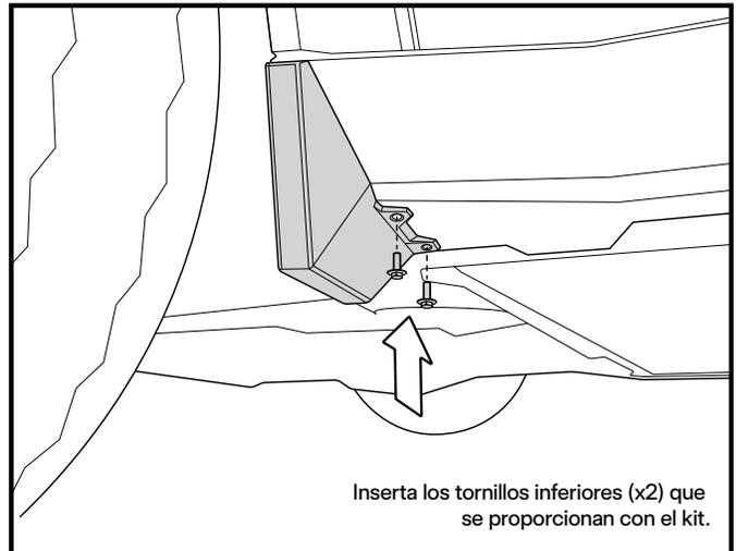
Inserta los tornillos inferiores (x2) que se proporcionan con el kit.
